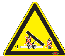
Abb. 6: Aufenthalt unter oder hinter angehobener Ladefläche verboten
