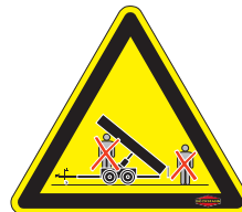
Afb. 6: Het verblijf onder of achter de opgeheven laadvloer is verboden
