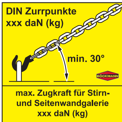
Fig. 11: Points d'arrimage sur la remorque Indique la capacité de charge des différents points d'arrimage sur la remorque.
